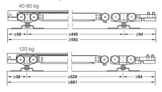
Version C with soft closing mechanism (both sides) แบบ C ระบบการปิดแบบนุ่มนวล (2 ด้าน)
