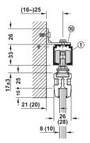
Wall mounting with wall mounting bracket ติดตั้งบนผนังด้วยเหล็กฉากติดผนัง
