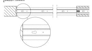
Mounting rail installation: Observe the position of the recesses การติดตั้งรางบน: ข้อแนะนำในการติดตั้ง คือ เรียงช่องของรางให้ตรง
