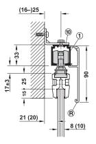
Wall mounting with wall mounting bracket and clip panel 90 mm การติดตั้งบนผนังด้วยเหล็กฉากติดผนัง และฝาครอบรางแบบคลิป 90 มม.
