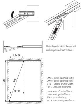
The length of top track must not exceed diagonal clearance (P2 - 80 mm) ความยาวของรางบนต้องไม่ยาวเกินช่องเปิดในแนวทแยงมุม (P2 - 80 มม.)
