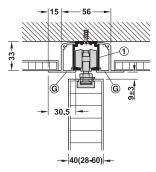
Ceiling installation with running track and 2 x clip panel for integration in suspended ceilings การติดตั้งบนเพดานด้วยรางและ ฝาครอบพร้อมแผ่นปิดด้านล่าง 2 ขึ้น
