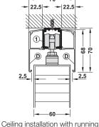
track and 2 x wide clip panel การติดตั้งบนเพดานด้วยรางและ ฝาปิดแบบคลิป 68 มม. 2 ขึ้น
