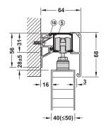
Wall mounting with running track, mounting rail high, width 19 mm, and clip panel 68 mm การติดตั้งบนผนังด้วยรางยึดผนัง กว้าง 19 มม. และฝาครอบรางแบบ คลิป 68 มม.
