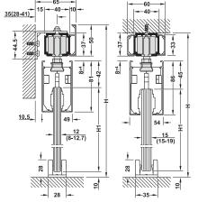
Glass thickness 8 – 12.7 mm H=door height/ H1=door height สำหรับกระจกหนา 8 - 12.7 มม. H=ความสูงรวม/ H1=ความสูงบานประตู Glass thickness 15 - 19 mm สำหรับกระจกหนา 15 - 19 มม.
