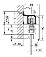
Wall mounting with running track and clip panel 90 mm การติดตั้งรางบนผนังและฝาครอบราง แบบคลิป 90 มม.
