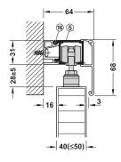
Wall mounting with running track, mounting rail, width 19 mm, and clip panel 68 mm การติดตั้งบนผนังด้วยรางยึดผนัง กว้าง 19 มม. และฝาครอบรางแบบ คลิป 68 มม.
