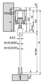
Wall installation with glass panel ติดตั้งบนผนัง สำหรับประตูบานกระจก
